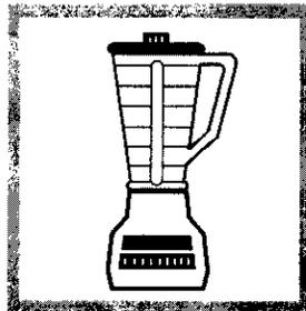
2. Homogenice la muestra en la licadora si es que contiene una gran cantidad de sólidos en suspensión o sedimentables.
