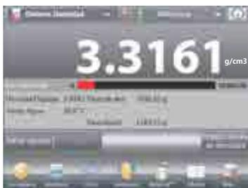
Una vez que se han determinado los pesos necesarios, la densidad de la muestra aparece en **g/cm<sup>3</sup>** (junto con el peso en aire y peso en agua) en la pantalla de aplicaciones.
