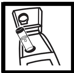
**2.** Inserte la cubeta de muestras en el compartimento y cierre la tapa. Presione I/O.
