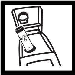
4. Coloque el patrón Gelex de 0-10 NTU en el compartimento de modo que el diamante de la ampolla quede alineado con la marca de orientación del instrumento. Cierre la tapa de la cubeta de muestras.
